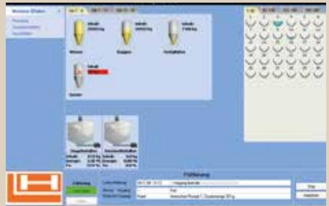
Übersicht der genauen Füllmenge in Silos, Anmischbehälter und Trögen
